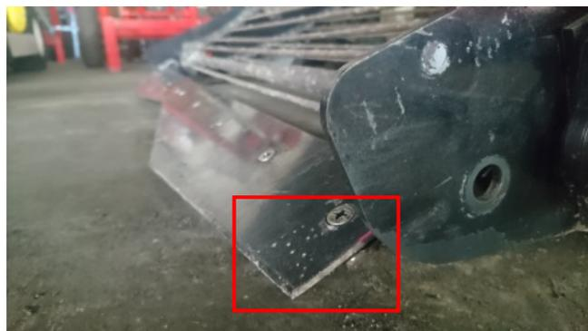
圖 10、調整挖掘角度
