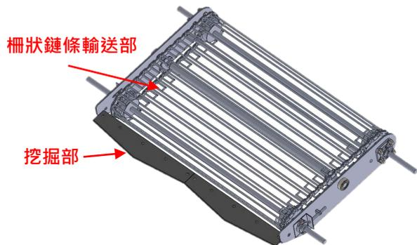
圖 4、挖掘部與柵狀鏈條輸送部組合示意圖
