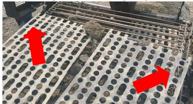
圖 11、隆起土塊使穴盤左右滑動
