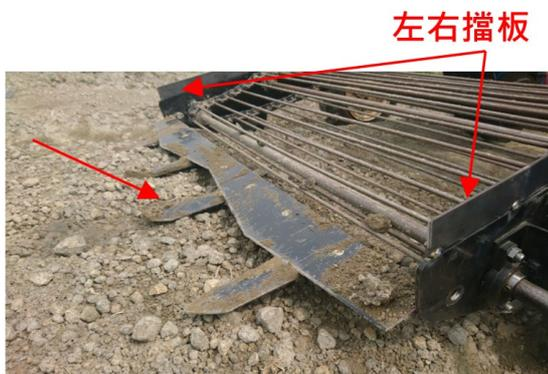
圖 12、延伸扶起刀與左右擋板
