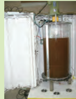
▲ 自動化微藻培養反應器（平直式葉片攪拌翼） Automatic bioreactor with flat-blade type impeller for microalgae cultivation
